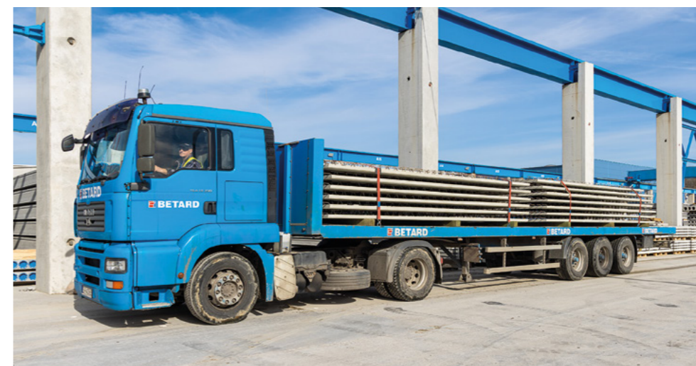
← TRANSPORT Załadunek płyt stropowych filigran zabezpieczonych pasami transportowymi.
