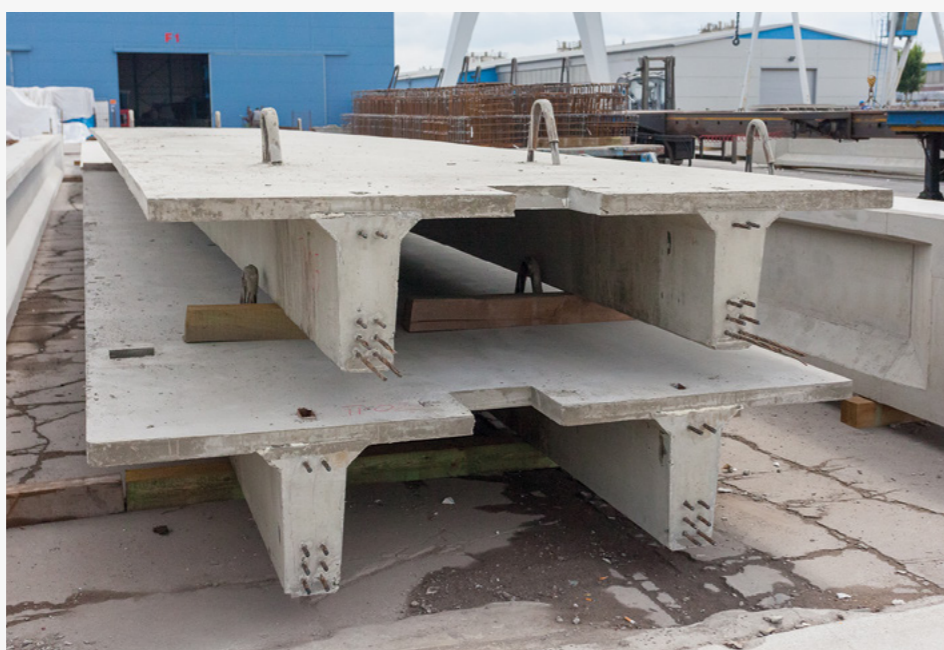
→ Składowanie sprężonych płyt stropowych TT.
