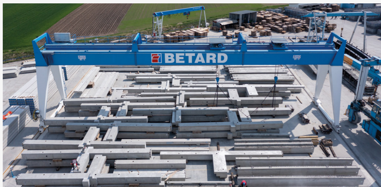
↑ PRODUKCJA Magazynowanie słupów wspornikowych.
