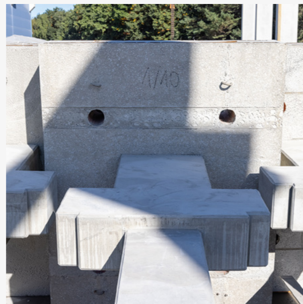
↑ PRODUKCJA Stropostup z dwustronnym wspornikiem.
