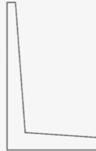
Ściana oporowa typu L o zmiennym przekroju
