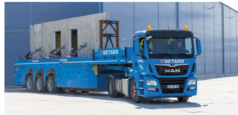
← TRANSPORT Transport prefabrykowanych ścian pełnych w przyczepie typu inloader.
