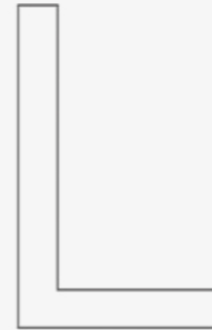
Ściana oporowa typu L o stałym przekroju
