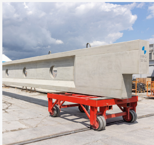
↑ PRODUKCJA Dźwigar sprężony jednoszpadowy z podcięciem w miejscu podparcia dźwigara.
