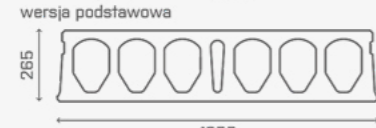
Przekrój poprzeczny płyt HCU320A
