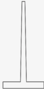
Ściana oporowa typu T o zmiennym przekroju
