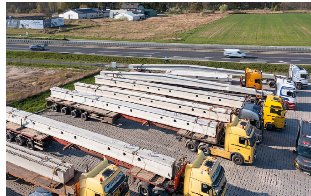
← TRANSPORT Przygotowane do wyjazdu samochody specjalistyczne z załadowanymi dźwigarami sprężonymi jedno- i dwuspadowymi.
