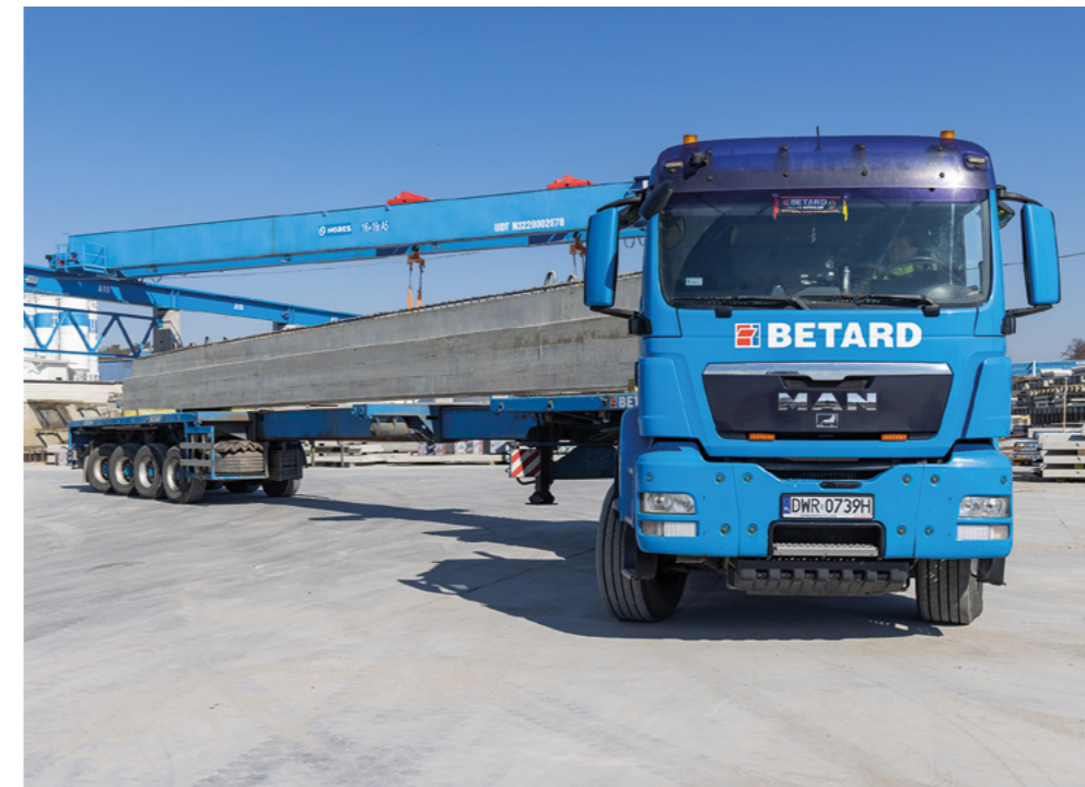
← TRANSPORT Transport belki sprężonej na naczepie niskopodwozowej z systemem rozciąg.
