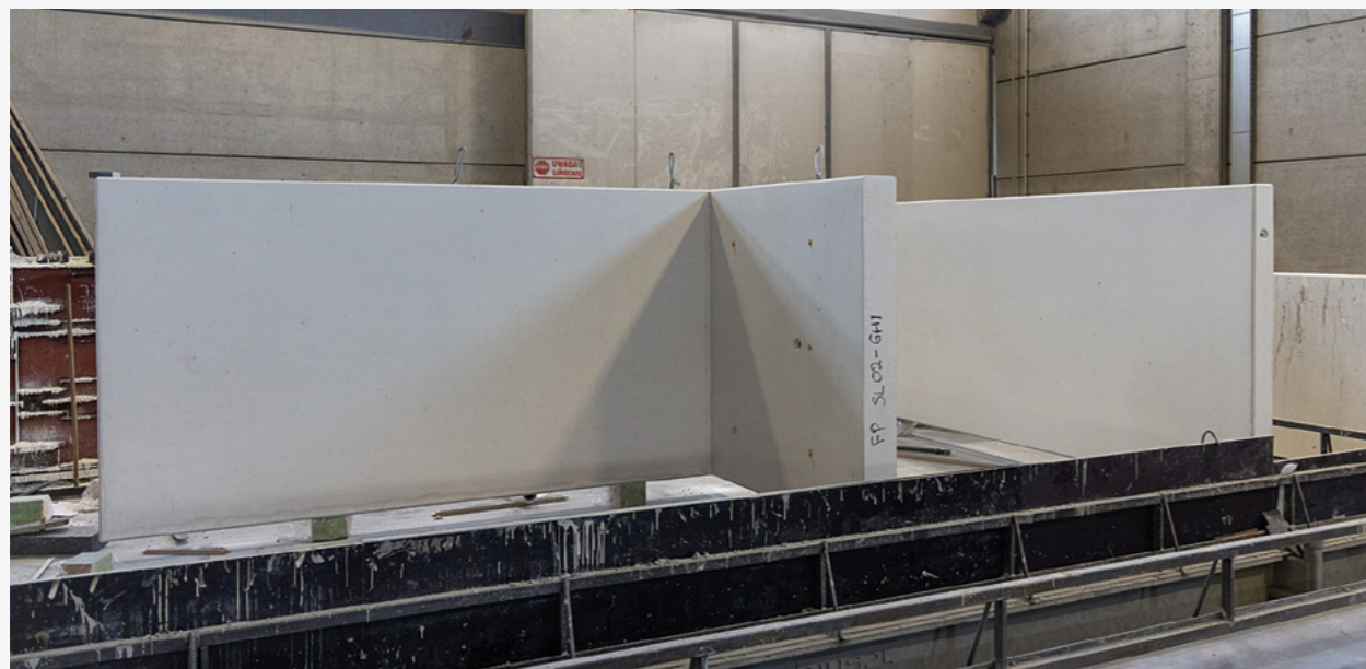
↑ PRODUKCJA Ściana oporowa po rozformowaniu.
