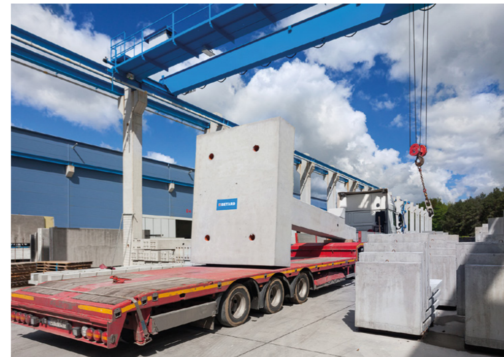
← TRANSPORT Załadunek stropostupa na naczepę niskopodwoziową.
