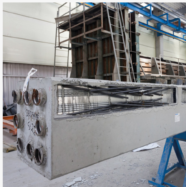
↑ PRODUKCJA Szyny ze zbrojeniem odginanym zamocowane w prefabrykacie.
